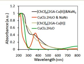
Fig. 8 UV-Vis normalized spectra of  $CuCl_2$  &  $NaN_3$ ,  $[ChCl]_4[2GA-Cu(III)]$  &  $NaN_3$ ,  $[ChCl]_4[2GA-Cu(III)]$ , and  $CuCl_2 \cdot 2H_2O$  in deionized water (0.0005 M).
