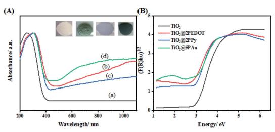
Fig. 6 (A) UV-Vis diffuse reflectance spectra of (a)  $TiO_2$  (b)  $TiO_2$ @2PEDOT, (c)  $TiO_2$ @2PPy, and (d)  $TiO_2$ @5PAn, (B) plots of transformed KM function.
