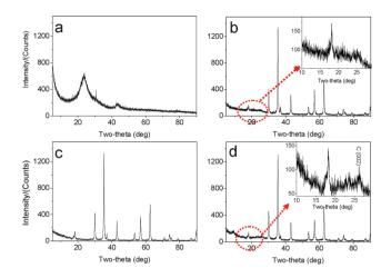
Fig. 2 XRD patterns of (a) original GNSs, (b) M1-GNS, (c) original Fe<sub>3</sub>O<sub>4</sub> nanoparticles, and (d) M2-GNS.
