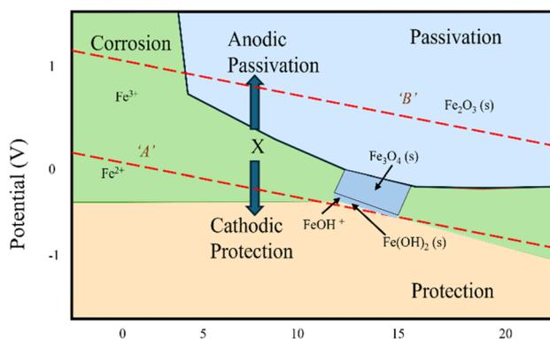
Fig. 3 Pourbaix diagram for steel.<sup>15</sup>
