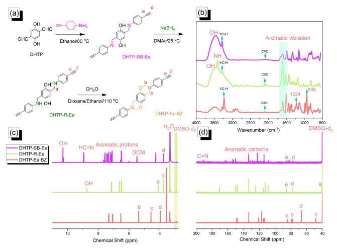
Fig. 2 (a) Synthesis of DHTP-Ea BZ from DHTP, DHTP-SB-Ea, and DHTP-R-Ea. (b-d) Corresponding (b) FTIR, (c) <sup>1</sup>H NMR, and (d) <sup>13</sup>C NMR spectra.
