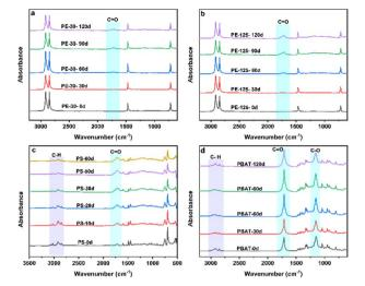
Fig. 2 The FTIR images of MPs, (a) PE-30; (b) PE-125; (c) PS-75; (d) PBAT-150.
