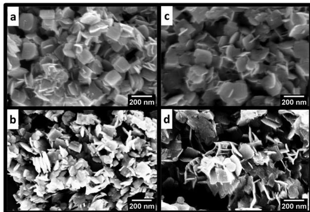
Fig. 3 SEM images of (a)  $\text{WO}_3$ \_180 °C-0 min, (b)  $\text{WO}_3$ \_200 °C-0 min, (c)  $\text{WO}_3\text{GO}$ \_180 °C-0 min and (d)  $\text{WO}_3\text{GO}$ \_200 °C-0 min.
