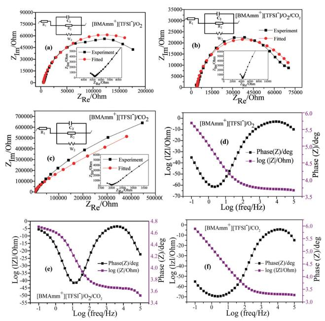
Fig. 6 Nyquist plots detected in (a)  $O_2$ -saturated-[BMAmm<sup>+</sup>][TFSI<sup>-</sup>], (b)  $O_2/CO_2$ -saturated-[BMAmm<sup>+</sup>][TFSI<sup>-</sup>] and (c)  $CO_2$ -saturated-[BMAmm<sup>+</sup>][TFSI<sup>-</sup>]. Bode plots detected in (d)  $O_2$ -saturated-[BMAmm<sup>+</sup>][TFSI<sup>-</sup>], (e)  $O_2/CO_2$ -saturated-[BMAmm<sup>+</sup>][TFSI<sup>-</sup>] and (f)  $CO_2$ -saturated-[BMAmm<sup>+</sup>][TFSI<sup>-</sup>].
