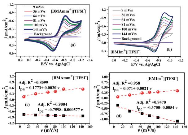
Fig. 3 CVs of O<sub>2</sub>• generation in (a) [BMAmm<sup>+</sup>][TFSI<sup>-</sup>] and (b) [EMIm<sup>+</sup>][TFSI<sup>-</sup>], and current density against sweep rate in (c) [BMAmm<sup>+</sup>][TFSI<sup>-</sup>] and (d) [EMIm<sup>+</sup>][TFSI<sup>-</sup>].
