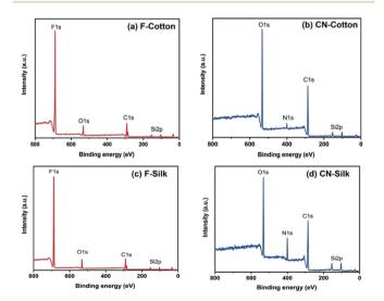
Fig. 4 XPS spectra of (a) F-cotton, (b) CN-cotton, (c) F-silk and (d) CN-
