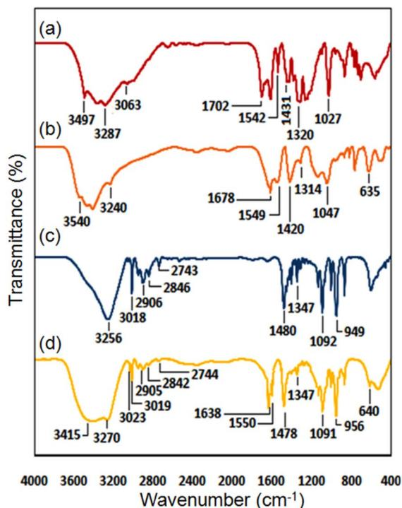
Fig. 3 FT-IR spectra of (a) GA, (b) 2GA-Cu(II), (c) ChCl, and (d) [ChCl]<sub>4</sub>[2GA-Cu(II)].
