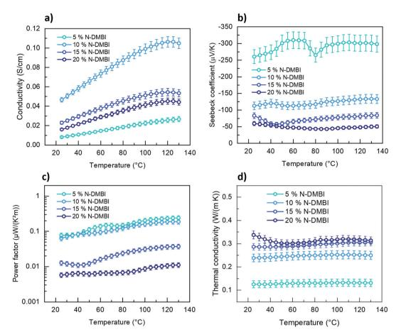
Temperature-dependent thermoelectric parameter of P1G (a)  $\sigma$ , (b)  $\alpha$ , (c) PF, and (d)  $\kappa_{\parallel}$ .
