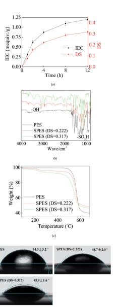
Fig. 1 PES sulfonation properties. (a) IEC and DS; (b) FTIR spectra; (c) TG and (d) CA.
