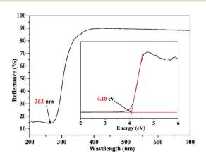
Fig. 3 UV-vis diffuse reflectance spectrum of  $Mg(H_2O)_6[(IO_2(OH))_2(IO_3)]_2$ .
