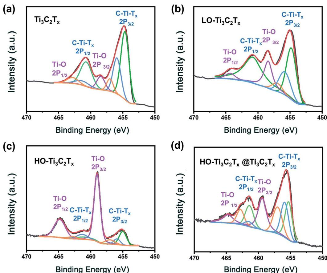
Fig. 3 Ti 2p core level XPS spectra of the films of (a)  $\text{Ti}_3\text{C}_2\text{T}_x$ , (b) LO- $\text{Ti}_3\text{C}_2\text{T}_x$ , (c) HO- $\text{Ti}_3\text{C}_2\text{T}_x$ , and (d) HO- $\text{Ti}_3\text{C}_2\text{T}_x@ \text{Ti}_3\text{C}_2\text{T}_x$ .
