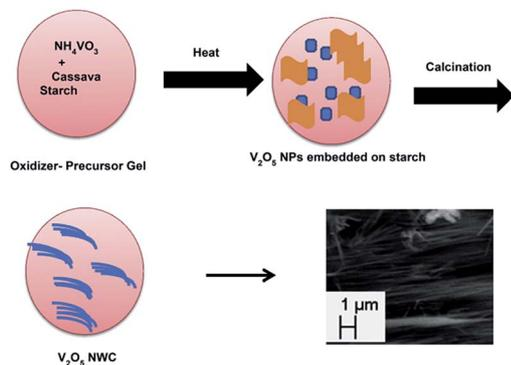
Fig. 4 Illustration of  $V_2O_5$  NWC formation.<sup>69</sup>
