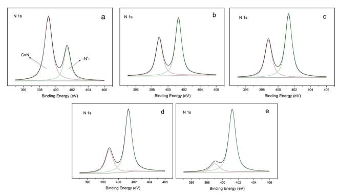
Fig. 1 XPS N 1s core-level spectra of the film-CDG: (a)  $n_T$ :  $n_D = 1$ : 0; (b)  $n_T$ :  $n_D = 2$ : 1; (c)  $n_T$ :  $n_D = 1$ : 1; (d)  $n_T$ :  $n_D = 1$ : 2; and (e)  $n_T$ :  $n_D = 0$ : 1 surface.
