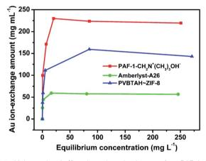
Fig. 3 Volumetric Au(i) adsorption isotherms for PAF-1-CH $_2$ - N $^+({\rm CH_3})_3{\rm OH}^-,$  Amberlyst-A26 and PVBTAH–ZIF-8.
