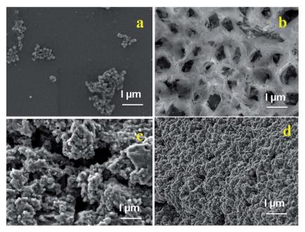
Fig. 4 SEM images of (a) Fe<sub>3</sub>O<sub>4</sub>; (b)  $\beta$ -CD-EDTA; (c)  $\beta$ -CD-EDTA-Fe<sub>3</sub>O<sub>4</sub>; (d)  $\beta$ -CD-EDTA-Fe<sub>3</sub>O<sub>4</sub>/CPT nano carrier.
