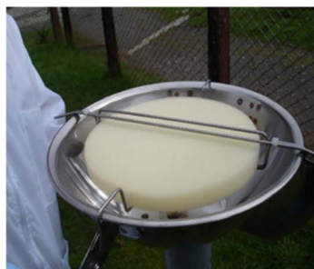
Fig. 3 Tracking the aerobiome using PUF-PAS. 76
