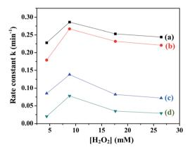
Fig. 9 Variation of rate constants with  $[H_2O_2]$  in the presence of (a)  $CuFe_2O_4$ , (b)  $ZnFe_2O_4$ , (c)  $NiFe_2O_4$  and (d)  $CoFe_2O_4$ .
