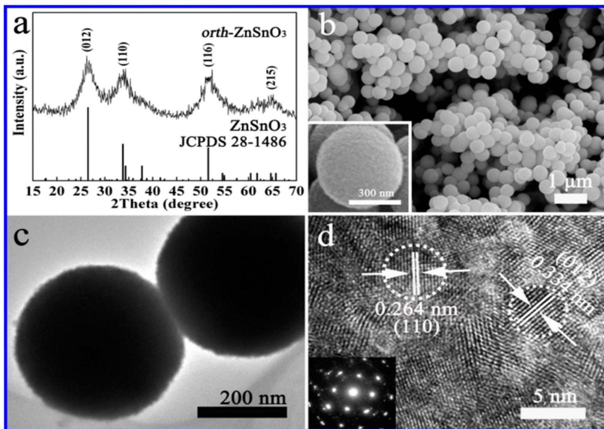
Fig. 7 (a) XRD pattern, (b) SEM image, (c) TEM image, and (d) HRTEM image of ZnSnO<sub>3</sub> solid microspheres.<sup>90</sup>
