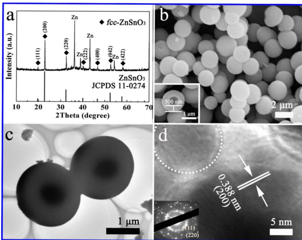
Fig. 8 (a) XRD pattern, (b) SEM image, (c) TEM image, and (d) HRTEM image of ZnSnO<sub>3</sub> hollow microspheres.<sup>90</sup>
