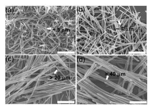
Fig. 5 The SEM images of the BF2bcz nanorods under different  $C_{\rm CTAB}$ . (a) 2.0 mg mL $^{-1}$ ; (b) 1.0 mg mL $^{-1}$ ; (c) 0.5 mg mL $^{-1}$ ; (d) 0.25 mg mL $^{-1}$ Scale bar: 5 um.
