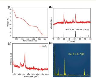
Fig. 3 (a) TG curve of  $CoS_x$  cages in in  $N_2$ . (b) XRD pattern, (c) Raman spectrum and (d) EDX spectrum of  $Co_9S_8$  cages.
