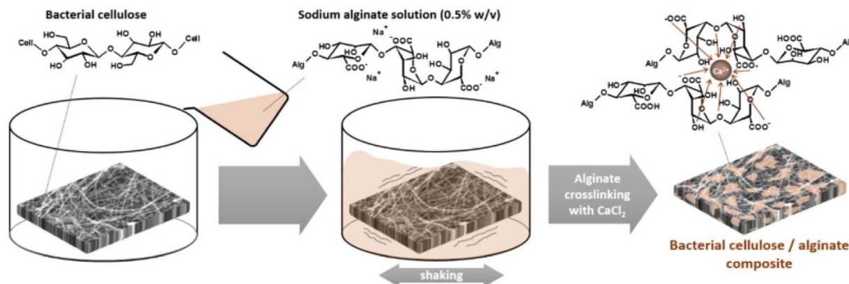
Fig. 8 Fabrication of bacterial cellulose/alginate composite.<sup>130</sup>
