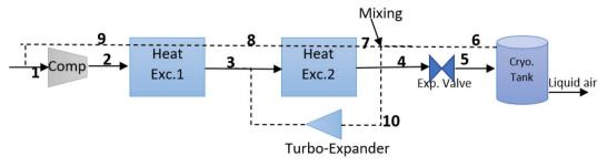
Fig. 5 Kapitza air liquefaction cycle.
