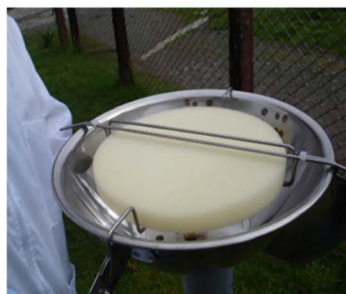
Fig. 3 Tracking the aerobiome using PUF-PAS. 76
