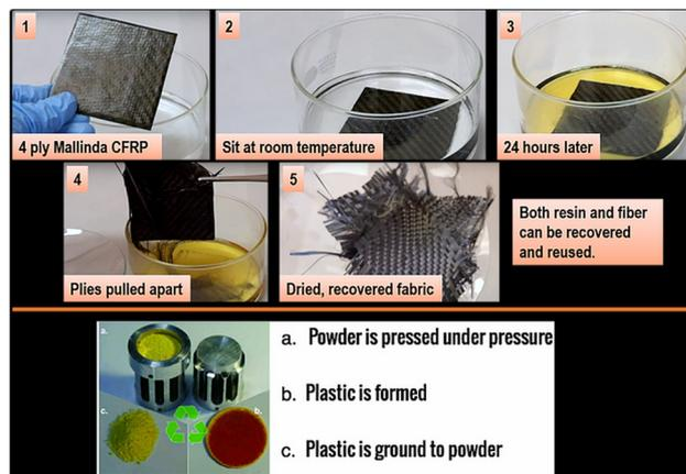
Fig. 20 Recycling of Mallinda's CFRP vitrimer.<sup>99</sup>
