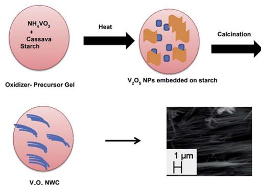
Fig. 4 Illustration of  $V_2O_5$  NWC formation.<sup>69</sup>
