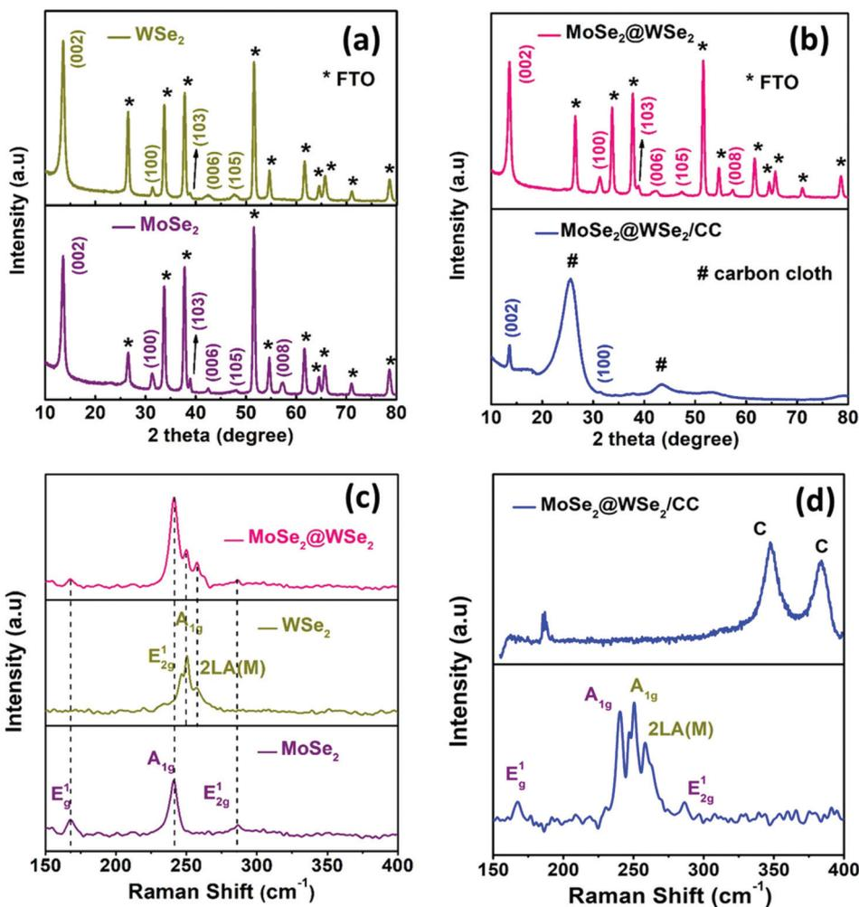
Fig. 3 XRD pattern (a)  $\text{WSe}_2$  and  $\text{MoSe}_2$  (b)  $\text{MoSe}_2@WSe_2/FTO$  and  $\text{MoSe}_2@WSe_2/CC$ . Raman spectra (c)  $\text{WSe}_2$  and  $\text{MoSe}_2$  (d)  $\text{MoSe}_2@WSe_2/FTO$  and  $\text{MoSe}_2@WSe_2/CC$ .
