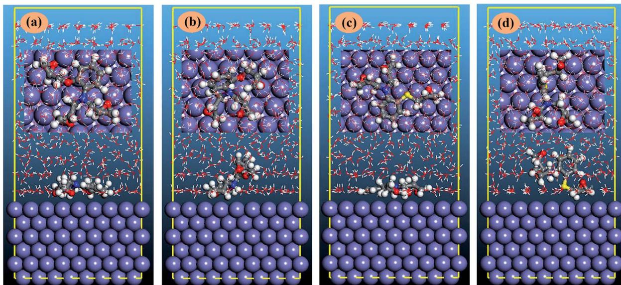
Fig. 9 The equilibrium configurations of (a) AEM1, (b) AEM1- $\text{H}^+$ , (c) AEM2, (d) AEM2- $\text{H}^+$  inhibitors adsorbed on Fe(110) surface.
