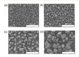
Fig. 6 SEM images of crushed PgFeTPP-DVB10 particles classified using sieves. (a)  $\sim$ 53  $\mu$ m, (b) 53-100  $\mu$ m, (c) 100-150  $\mu$ m, and (d) 150-250 µm.
