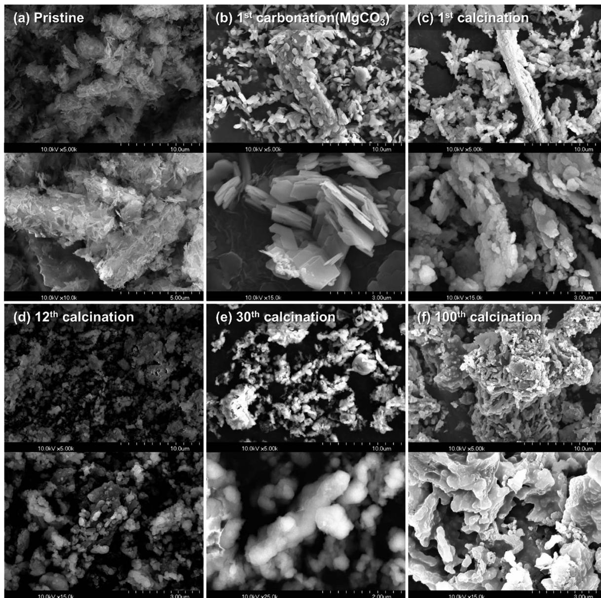
Fig. 6 SEM images of MgO/CNT\_Air: (a) pristine, (b) 1<sup>st</sup> carbonation (MgCO<sub>3</sub>), (c) 1<sup>st</sup> calcination, (d) 12<sup>th</sup> calcination, (e) 30<sup>th</sup> calcination, and (f) 100<sup>th</sup> calcination.
