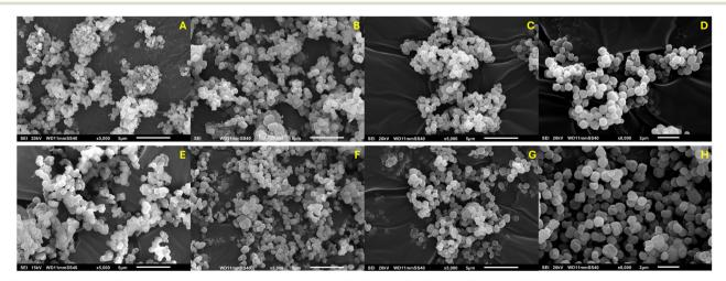
Fig. 5 SEM images of MFI growth over time under silent conditions: (A) 30 min, (B) 45 min, (C) 60 min, (D) 120 min; and under ultrasonication: (E) 30 min, (F) 45 min, (G) 60 min, (H) 120 min.
