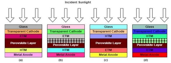
Fig. 2 PSC device architectures: (a) n-i-p planar, (b) n-i-p mesoscopic, (c) p-i-n planar, and (d) p-i-n mesoscopic
