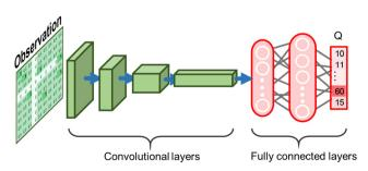
Fig. 5 Sketch of the structure of DQN.
