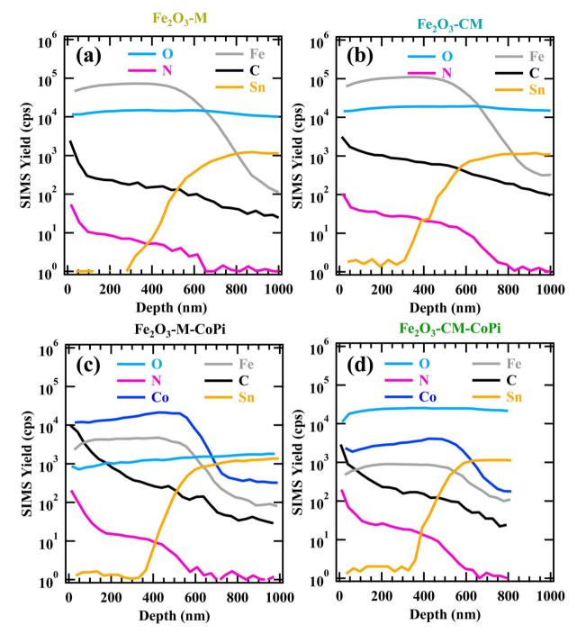
SIMS depth profiles of specimens:  $Fe_2O_3-M$  (a),  $Fe_2O_3-CM$  (b),  $Fe_2O_3-M-CoPi$  (c), and  $Fe_2O_3-CM-CoPi$  (d).
