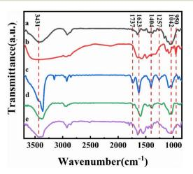
FTIR spectra (a) cellulose; (b) DES; (c) GO; (d) rGO; (e) CGF-2.
