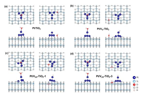
Fig. 6 Structures for \*H<sub>2</sub>O and \*OH/\*H adsorbed on the (a) Pt/TiO<sub>2</sub>, (b) Pt/V<sub>O</sub>—TiO<sub>2</sub>-1, (d) Pt/V<sub>2O</sub>—TiO<sub>2</sub>-3 surfaces.
