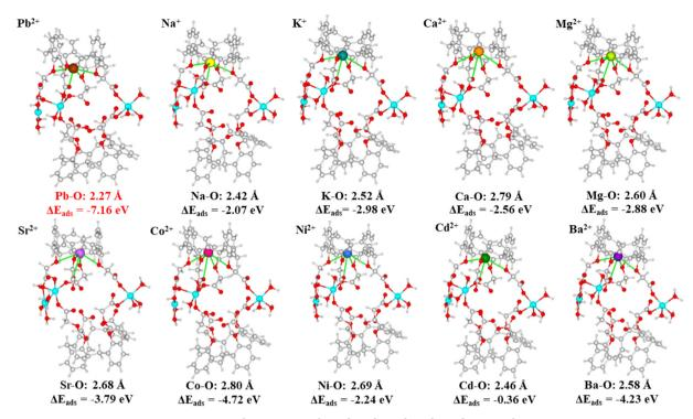
Fig. 10 DFT calculation models for metal ions of Pb<sup>2+</sup>, Na<sup>+</sup>, K<sup>+</sup>, Mq<sup>2+</sup>, Ca<sup>2+</sup>, Sr<sup>2+</sup>, Co<sup>2+</sup>, Ni<sup>2+</sup>, Cd<sup>2+</sup>, and Ba<sup>2+</sup>.
