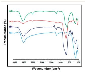
Fig. 2 FT-IR spectra of the (a) Fe $_3$ O $_4$ , (b) Fe $_3$ O $_4$ @SiO $_2$ @KCC-1, (c) Fe $_3$ O $_4$ @SiO $_2$ @KCC-1@MPTMS, and (d) Fe $_3$ O $_4$ @SiO $_2$ @KCC-1@MPTMS@Cu $^{II}$  nanosystems.
