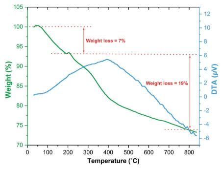
Fig. 7 TGA/DTA diagram of the  $Fe_3O_4$ @Si $O_2$ @KCC-1@MPTMS@Cu<sup>II</sup> nanocomposite.
