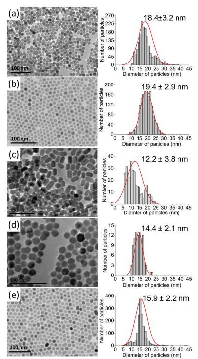
Fig. 2 TEM images recorded for (a) NaYF<sub>4</sub>:2%Tm³+@NaYF<sub>4</sub>, (b) NaYF<sub>4</sub>:2%Tm³+,5%Er³+@NaYF<sub>4</sub>, (c) NaYF<sub>4</sub>:2%Tm³+@NaYF<sub>4</sub>:5%Er³+, (d) NaYF<sub>4</sub>:18% Yb³+,2%Tm³+@NaYF<sub>4</sub>, and (e) NaYF<sub>4</sub>:18%Yb³+,2%Tm³+@NaYF<sub>4</sub>:5%Er³+NPs.
