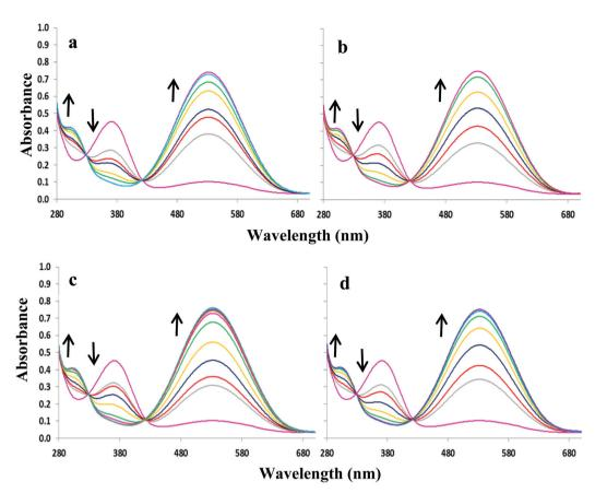
Fig. 3 UV-visible absorption spectra of  $2.7 \times 10^{-5}$  M 3 in 9:1 DMSO- $H_2O$  upon addition of various anions as sodium salts: (a) OH<sup>-</sup> (0-4 equivalents), (b) F<sup>-</sup> (0-4 equivalents), (c) AcO<sup>-</sup> (0-4 equivalents) and (d)  $H_2PO_4^-$  (0-40 equivalents.).
