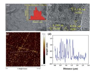
Fig. 3 (a) TEM image, (b) HRTEM image, (c) AFM image, and (d) height profile of CNDs.
