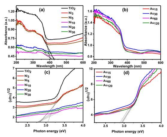
Fig. 9 Diffuse reflectance UV-visible spectra of (a)  $TiO_2NTs$  and  $Ni_x/TiO_2NTs$  photoanodes, and (b)  $Au_y/Ni_{20}/TiO_2NTs$  photoanodes. Tauc plot of (c)  $Ni_x/TiO_2NTs$  and (d)  $Au_y/Ni_{20}/TiO_2NTs$ .
