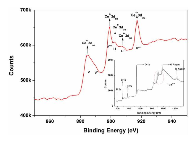
Fig. 7: XPS spectra of  $K_2Ce(PO_4)_2$ .
