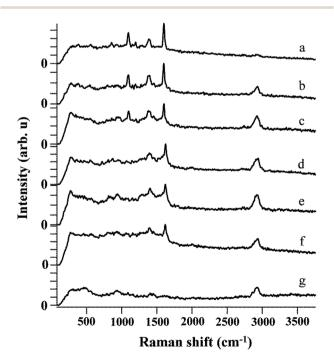
Fig. 5 SERS spectrum of MBA on SERS substrate with concentrations of (a)  $10^{-3}$  M, (b)  $10^{-5}$  M, (c)  $10^{-7}$  M, (d)  $10^{-9}$  M, (e)  $10^{-11}$  M, (f)  $10^{-13}$  M, (g) 0 M.
