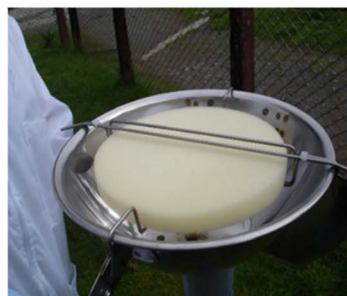
Fig. 3 Tracking the aerobiome using PUF-PAS. 76
