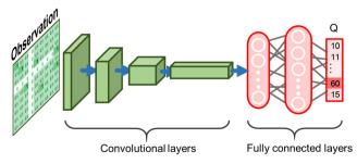
Fig. 5 Sketch of the structure of DQN.
