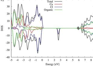
Fig. 8 DOS of (a)  $(C_5H_8N_3)[CuCl_3]$  and (b)  $(C_5H_{14}N_2)[CuCl_4]$ .
