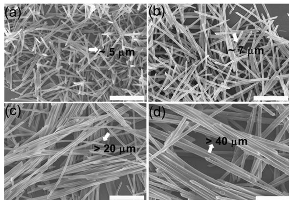
Fig. 5 The SEM images of the BF<sub>2</sub>bcz nanorods under different  $C_{\text{CTAB}}$ . (a) 2.0 mg mL<sup>-1</sup>; (b) 1.0 mg mL<sup>-1</sup>; (c) 0.5 mg mL<sup>-1</sup>; (d) 0.25 mg mL<sup>-1</sup>. Scale bar: 5 μm.
